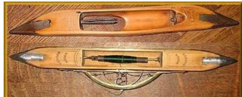
Navettes pour métiers à tisser à bras : navette à main (en haut) navette volante (en bas)
